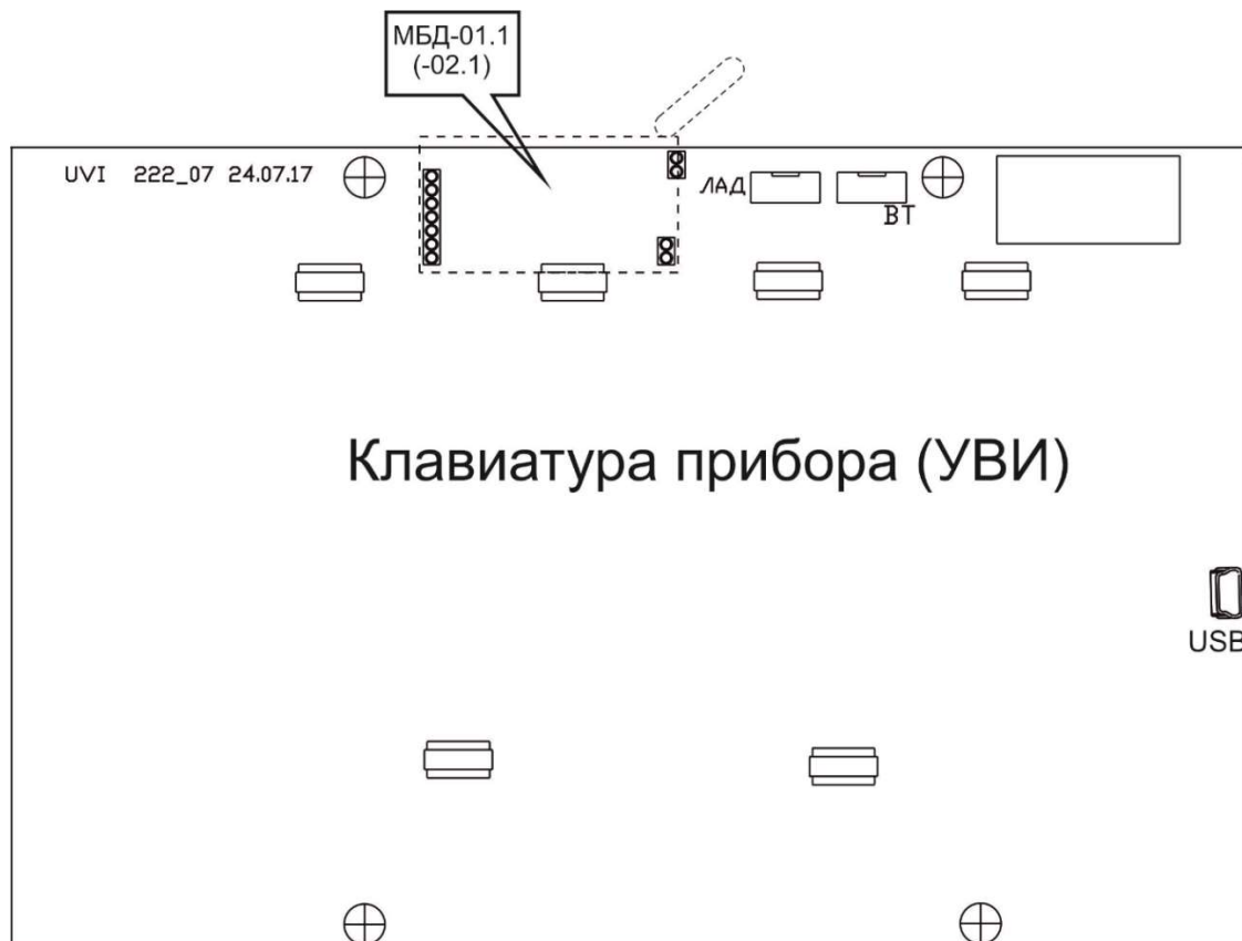
Рисунок 53 – Установка модулей беспроводных датчиков на плату УВИ
